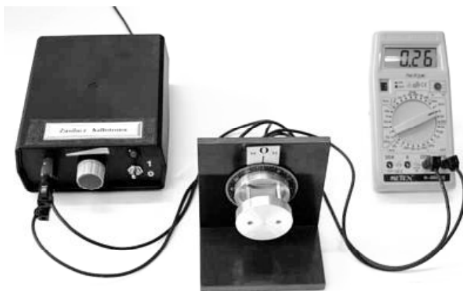
Rys.2. Układ do badania zjawiska Halla
